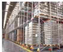
El rack shuttle (satelital) es una solución de almacenaje compacta semiautomatizada para tarimas que utilizan carros motorizados, que realizan los desplazamientos de las posiciones de forma autónoma.
