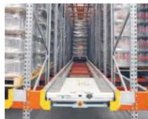
Almacenaje de alta rotación, permite la carga y la descarga automática de pallets de forma continua.
