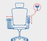
**Brazos ajustables en altura, apertura y giro (apertura del brazo en forma mecánica mediante la perilla)**
